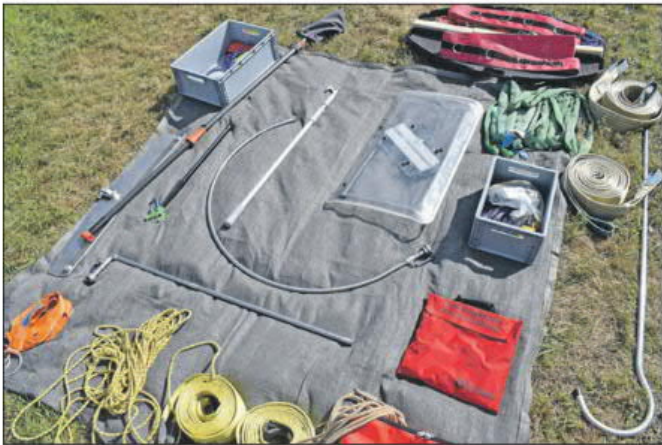
Sicherungsgurte, Fädelstangen, Bauchgurte und Kopftuch sind wichtiger Bestandteil, für die technische Großtierrettung
